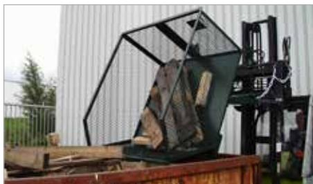
Version spécifique: benne basculante grillagée de type GU-G
