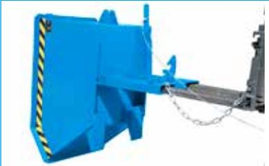
De part sa conception compacte et son hauteur réduite, cette benne vous permet un volume de remplissage optimisé et grâce à son mécanisme de basculement idéal un vidage total. Le basculement se fait rapidement par le système de déblocage par câble. Il est également possible de la vider en posant le bac de la benne sur le rebord du contenant, de déclencher et de faire monter doucement le mat.
