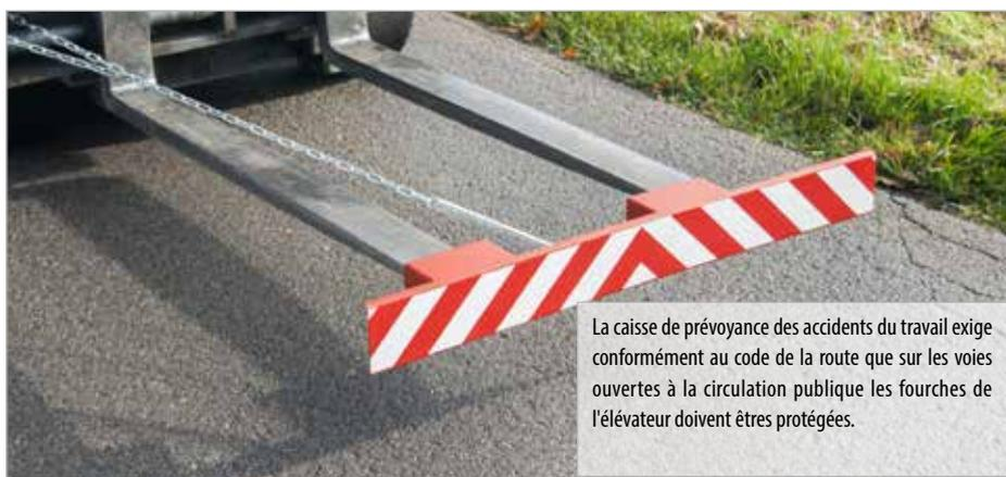
La caisse de prévoyance des accidents du travail exige conformément au code de la route que sur les voies ouvertes à la circulation publique les fourches de l'élevateur doivent être protégées.
