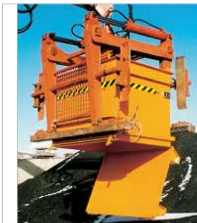
BC avec déverrouillage du fond par pince lève-blocs
