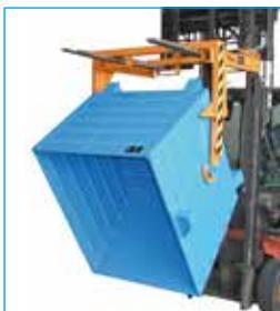
Ces bennes n'ont pas de mécanisme de basculement intégré et sont de ce fait une alternative attractive à petit prix. Indépendamment du nombre de conteneurs utilisés à largeur identique, un seul palonnier de vidage est nécessaire. Pour les bennes sans tourillons, un chariot élévateur à tête rotative est nécessaire pour effectuer le vidage.
